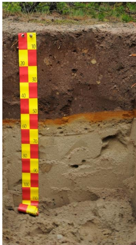
Przykład gleby technogenicznej powstałej na fragmentach zbudowanych z zasiarczonych i nadmiernie kwaśnych utworów mioceńskich poddanych neutralizacji na zwałowisku zewnętrznym Pola Belchatów.
